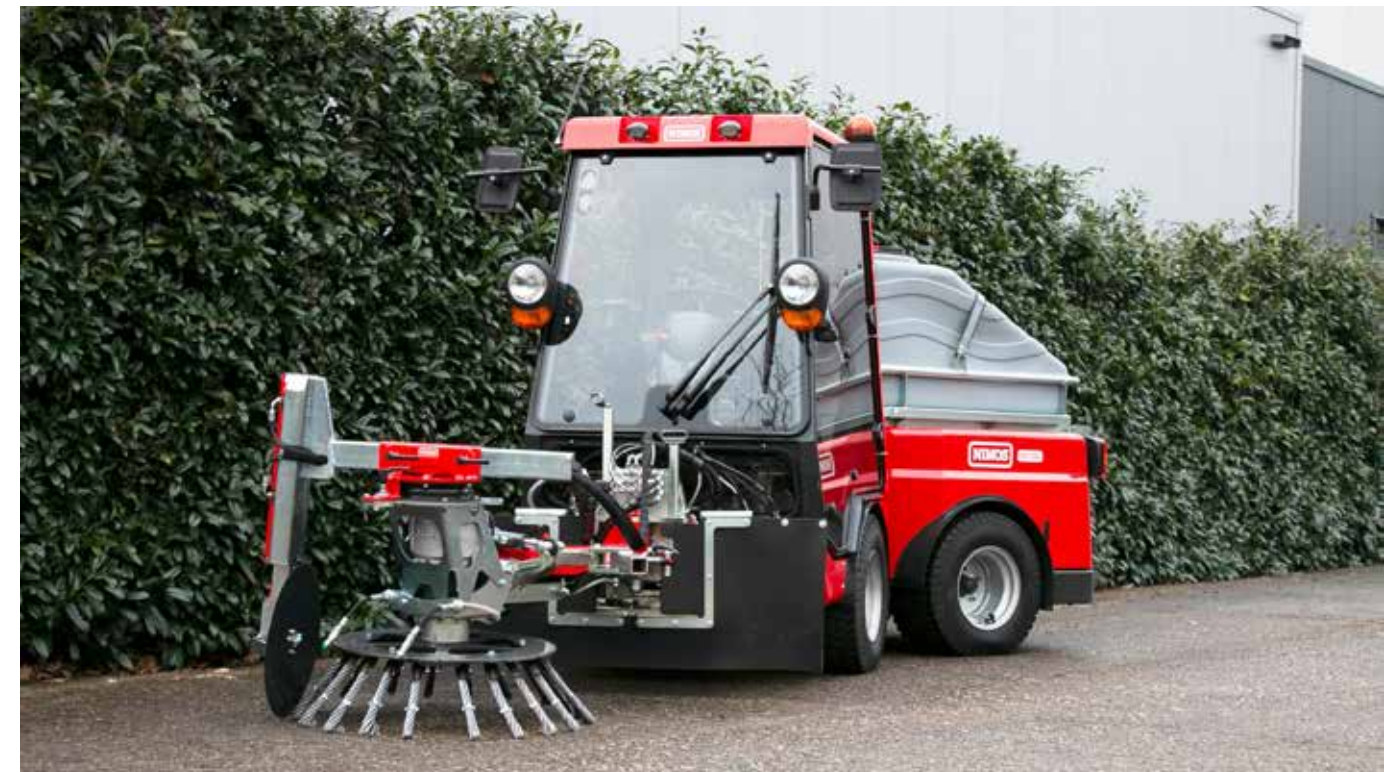
Er kunnen vandaag zes verschillende instrumenten aan de werktuigdrager gekoppeld worden, die automatisch door de machine herkend worden.
